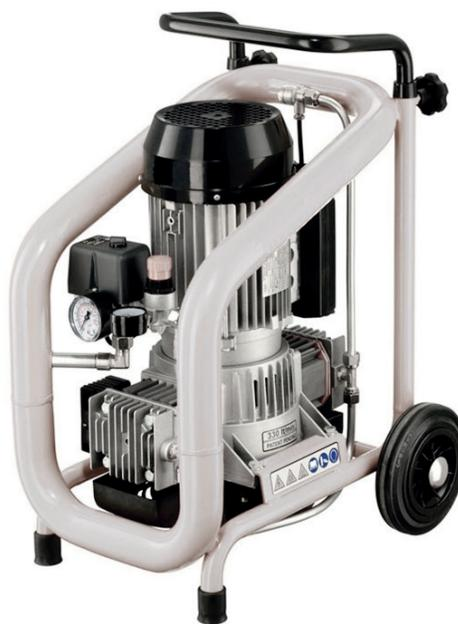
Компактный воздушный компрессор С330 надежно обеспечит Ваши строительные работы сжатым воздухом без примесей масла.
